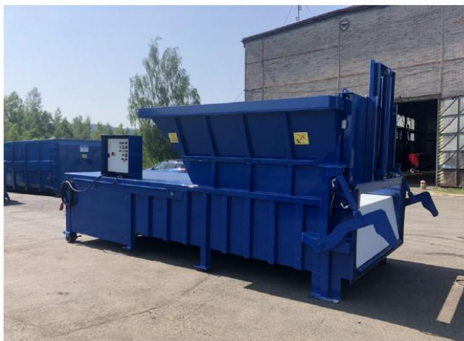
Obr. 7: Automatická překládací stanice a stacionární lis VSP 70 [zdroj: objednatel]
