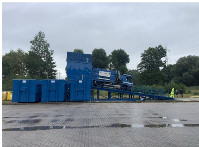
Obr. 7: Automatická překládací stanice a stacionární lis VSP 70 [zdroj: objednatel]
